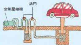
用壓縮空氣在油面施壓力將汽車舉起
